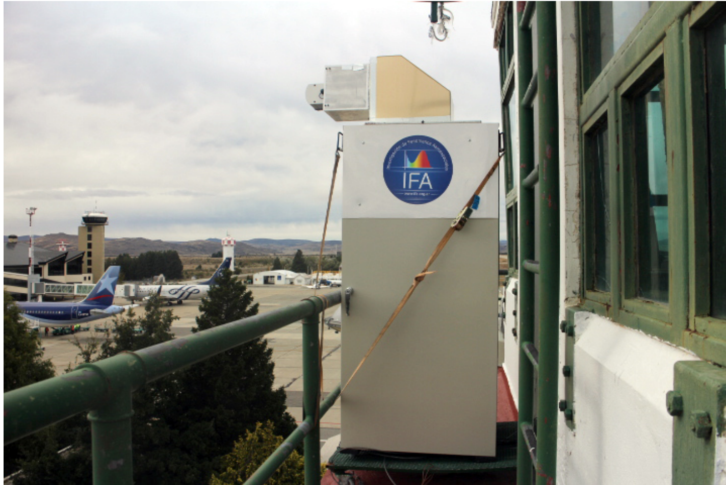
Sistema Integrado para el Análisis Espectral de Luces de Origen Desconocido. Ubicación: Aeropuerto Internacional de San Carlos de Bariloche - Argentina - "OLD-TWR"
